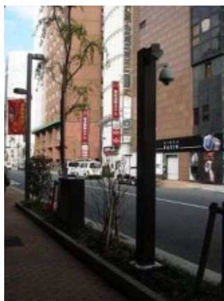
タクシー乗り場の“入り口”（最後尾）に設置されたETCアンテナ。乗り場に並ぶタクシーが登録された車両かどうかをチェックする（提供：東京都都市整備局）
