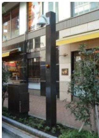
「銀座1号タクシー乗り場」に設置されたETCアンテナ。ETCにより登録車両かどうか分かり、登録車両では黄色の警告灯が点灯して離脱を促す。また近くに設置したカメラがナンバーを自動撮影する仕組みにもなっている（提供：東京都都市整備局）
